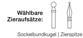
Unser Modell „Hamburg“ ist die etwas leichtere Ausführung des Modells „Hamburg-Hespen“. Zwischen parallelen Flacheisen werden senkrecht Vierkantrohre mit wahlweise oben aufgeschweißter Zierspitze oder Sockelbundkugel im Abstand von ca. 110 mm verschweißt. Zusätzlich sind im oberen Bereich Zierringe eingearbeitet.
