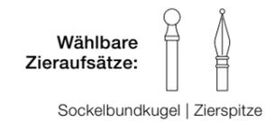
Unser Modell „Nizza“ ist die etwas leichtere Ausführung des Modells „Nizza-Hespen“. Zwischen parallelen Flacheisen sind senkrecht Vierkantrohre mit wahlweise oben aufgeschweißter Zierspitze oder Sockelbundkugel verschweißt. Zusätzlich ist im oberen Bereich ein Kreuzmuster eingearbeitet.
